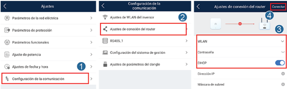
Figura C-2 Configuración de los parámetros del router
