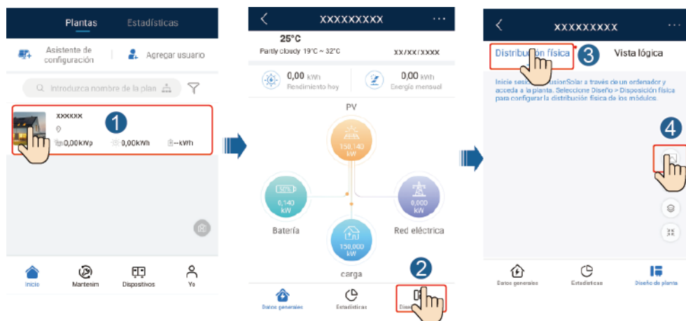
Figura 7-4 Carga de una foto de plantilla de diseño físico (aplicación)
